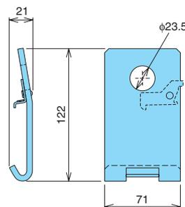
Fixed type AE400-SW, AE500-SW, AE630-SW
